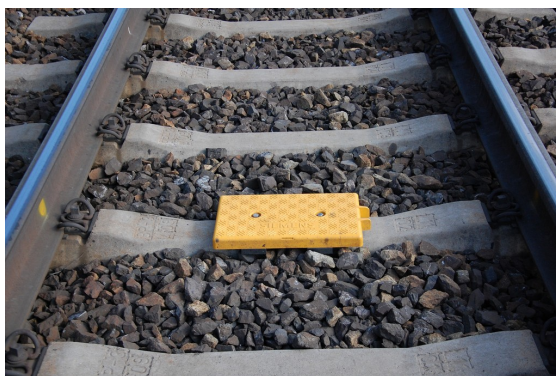
■ Obrázek 2.1 Eurobalíza v kolejnici. Získáno z [8]
