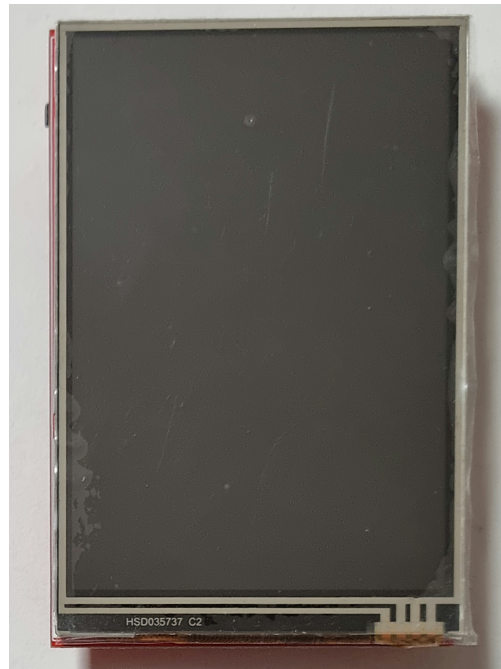
■ Obr. 3.4 TFT displej modul MAR3501; pohľad spredu
