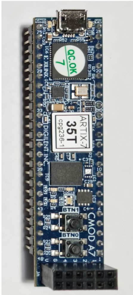
■ Obr. 3.1 Digilent Cmod A7-35T; pohľad spredu ■ Obr. 3.2 Digilent Cmod A7-35T; pohľad zozadu
