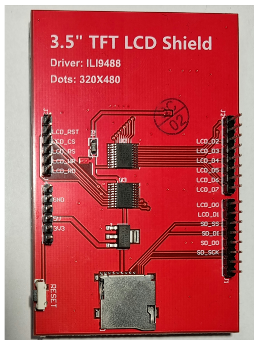
■ Obr. 3.5 TFT displej modul MAR3501; pohľad zozadu
