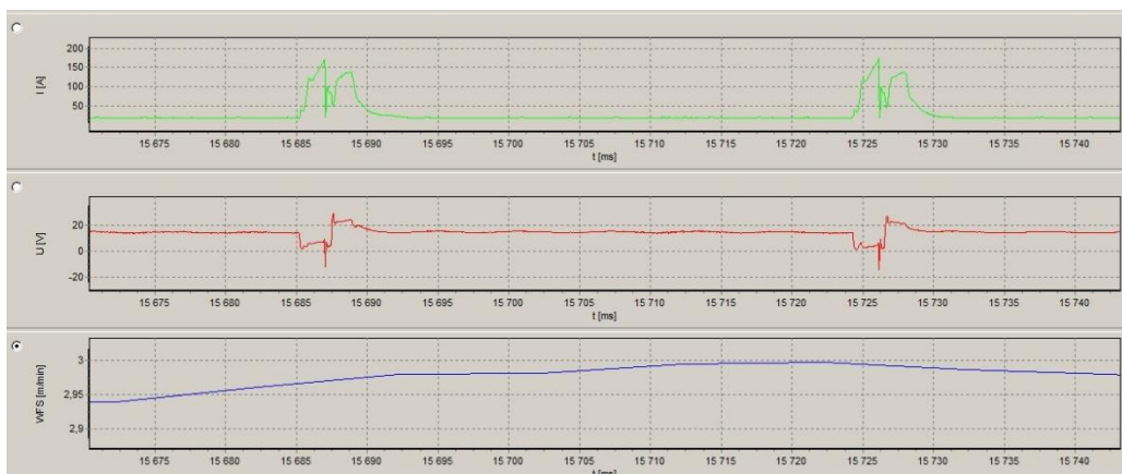
Obrázek 53 : Detail záznamu průběhu svařování 15. housenky výsledného segmentu
