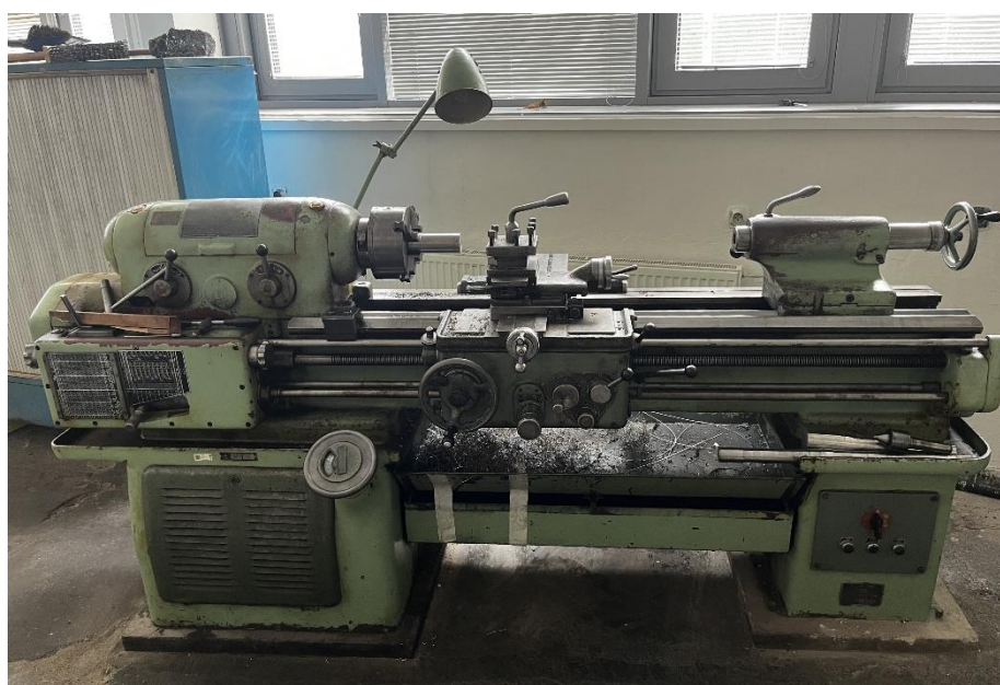
Obrázek 17 - Konvenční soustruh TOS SV 18 R
