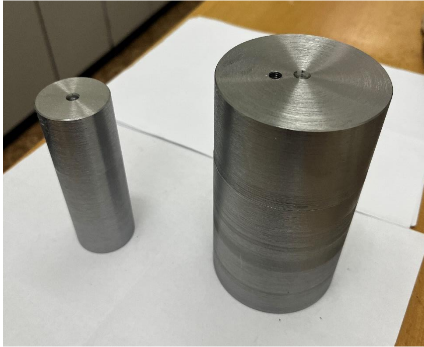
Obrázek 20 - Obrobené součásti v měkkém stavu
