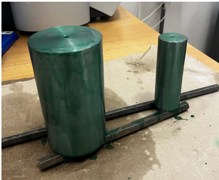
Obrázek 21 - Aplikace ochranného nátěru CONDURSAL Z1100
