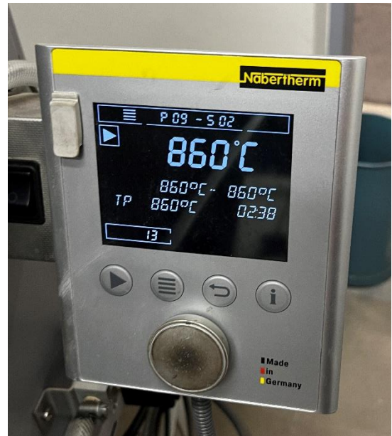
Obrázek 25 - Nastavení teploty v peci
