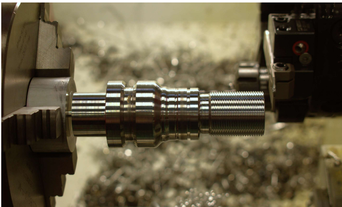
Obrázek 55 – Součást po obrobení – s cykly a korekcemi
