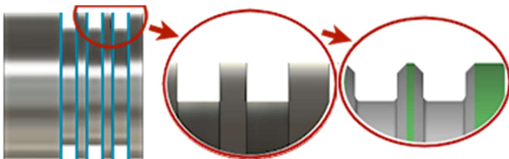
Obrázek 26 - Detail sražení hran [4]
