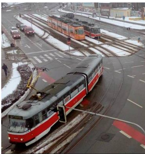
Obrázek 3: Křížení pozemní komunikace s kolejovou dráhou, v jehož místě se jízda kolejového vozidla řídí pravidly silničního provozu a nejedná se tak o železniční přejezd [42]
