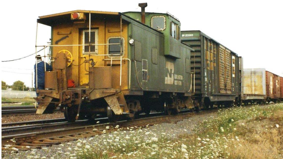
Obrázek 8 Služební vůz (angl. caboose) na železnici ve státě Illinois (zdroj [21])
