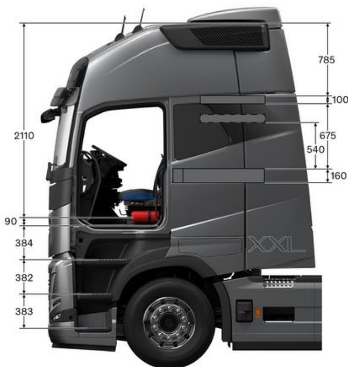
Obrázek 10 - Rozměry kabiny nákladního vozidla Volvo FH 13 (rozměry uvedené v mm); zdroj [10]
