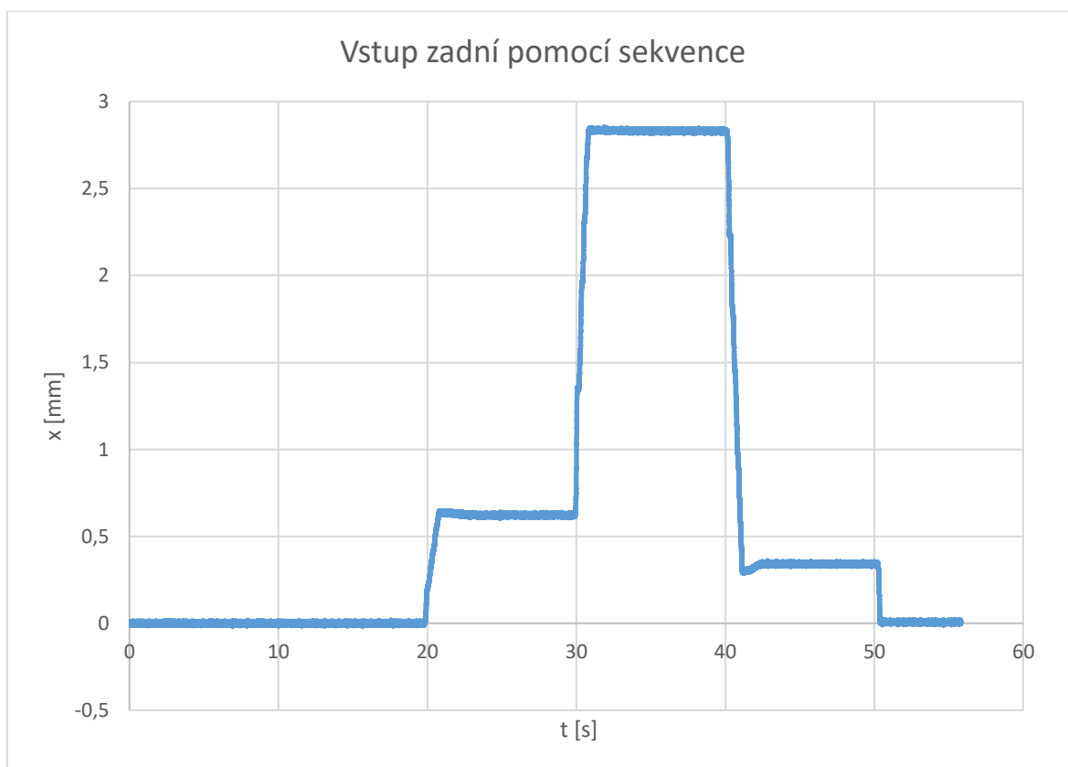
Graf 5 Posuny odečteny pomocí potenciometru umístěného na levém kole na přední nápravě
