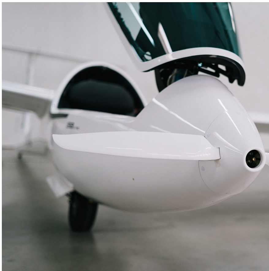
Obrázek 1.2: Detail přídě větroně LS8 vybaveného pohonnou jednotkou FES[7]
