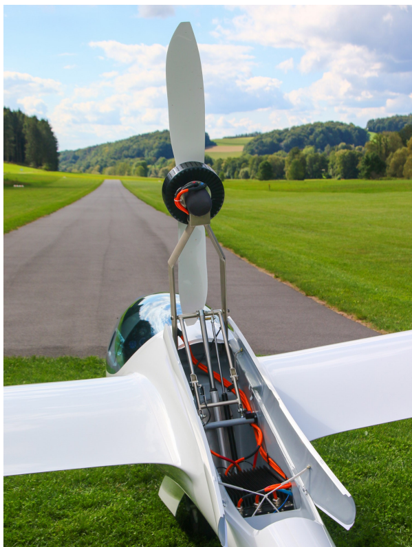
Obrázek 1.1: Zatahovací elektrická pohonná jednotka větroně AS34Me[5]
