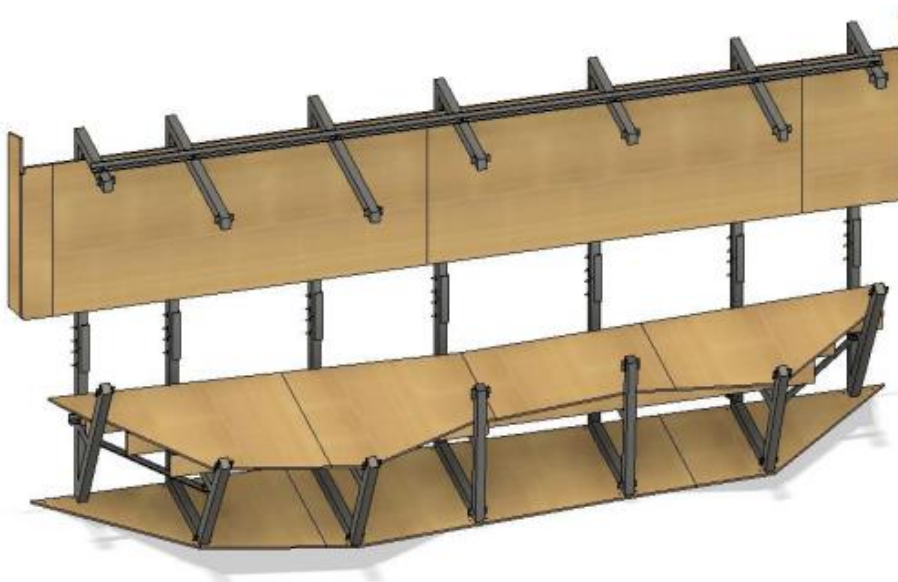
Obrázek 11 3D model ocelové konstrukce s dnem květináče
