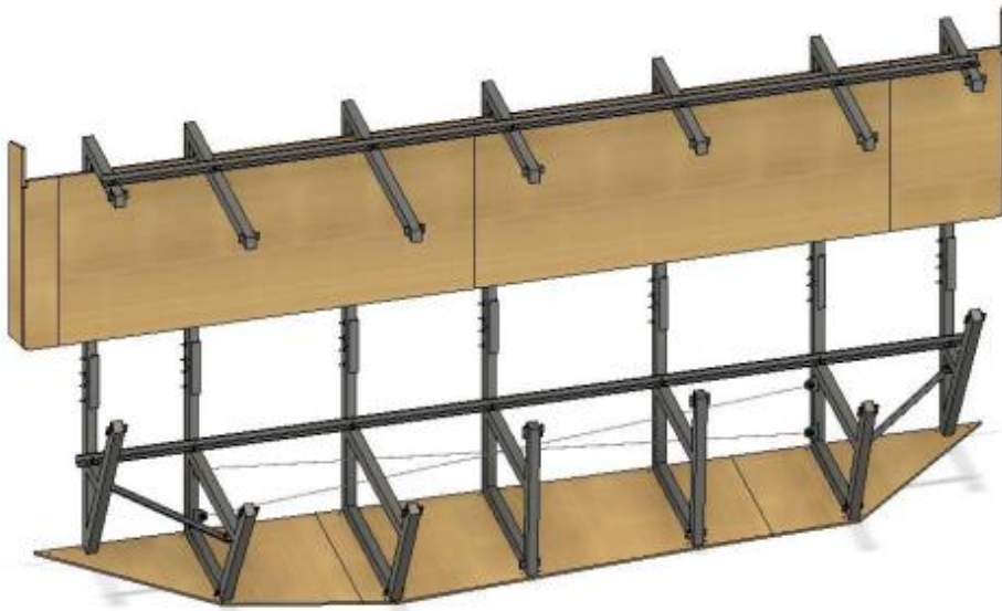
Obrázek 10 3D model zadního opláštění na ocelové konstrukci
