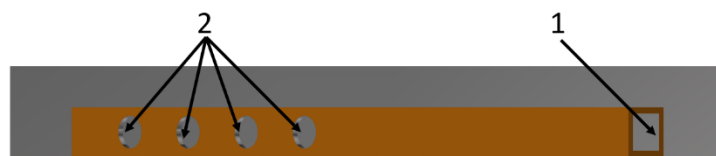
Obr. 22 Detail přívodu argonu do inertního boxu; 1 – Přívod argonu; 2 – Otvory pro přívod argonu do prostoru navařování;
