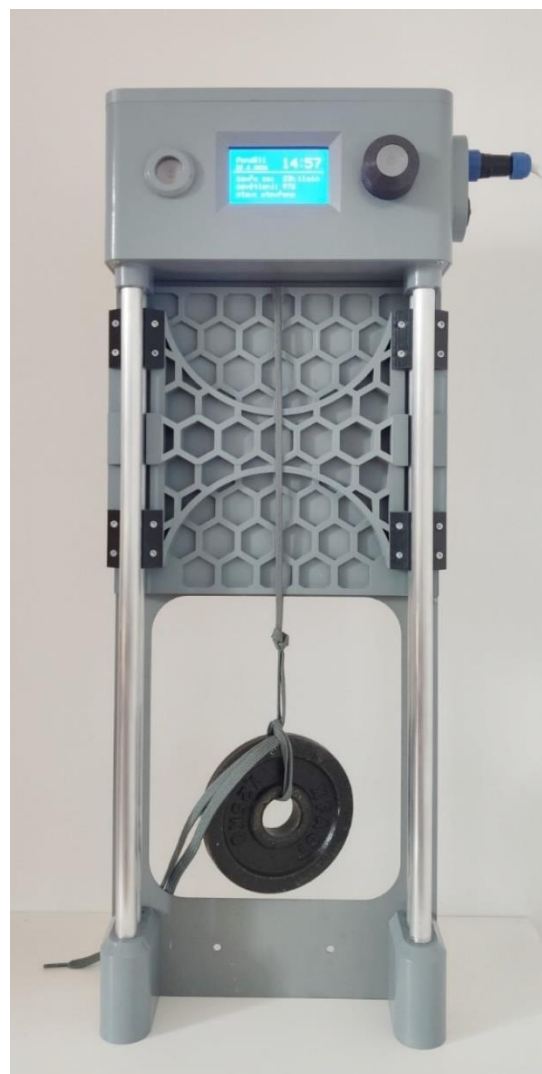
Obrázek 60: Zatížení dvířek hmotností 1,25 kg
