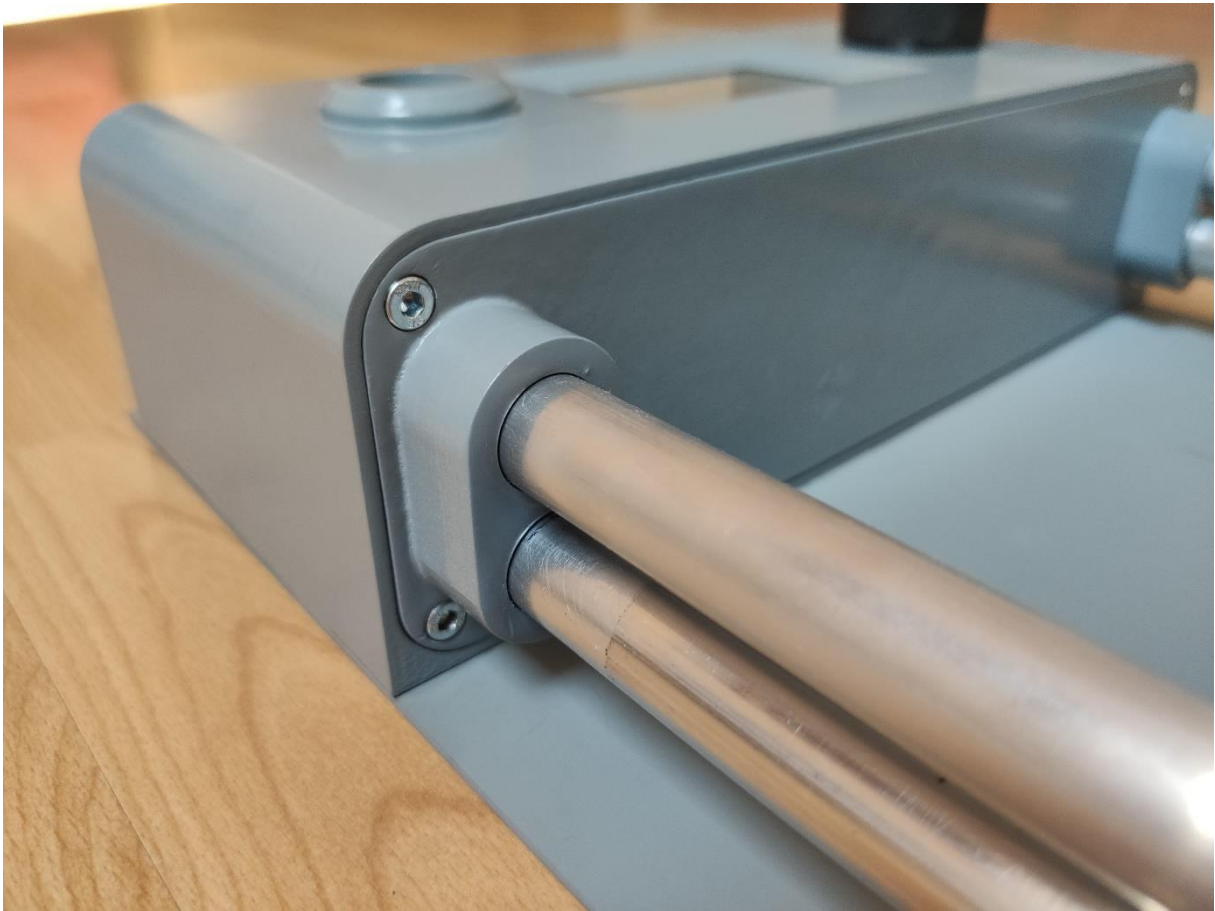
Obrázek 75: Pohled na uchycení lineárních tyčí do horní části zařízení
