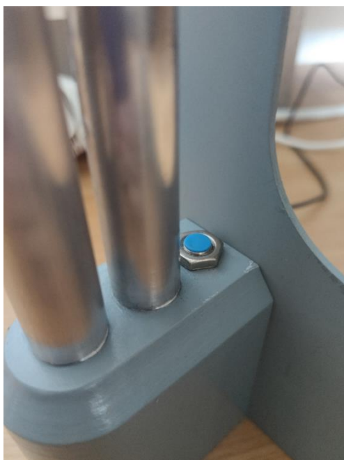
Obrázek 55: Indukční senzor umístěný v dolní části dvířek
