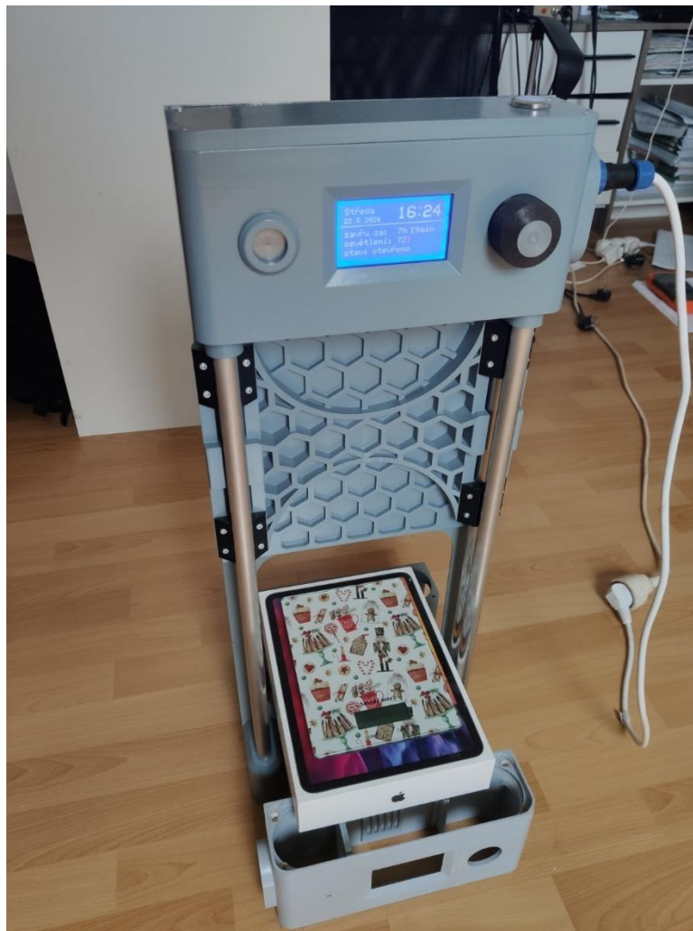
Obrázek 61: Měření působení síly dvířek na překážku
