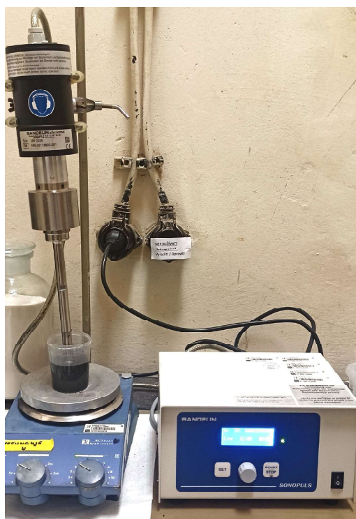
Obr. 4-4 Ultrazvukový homogenizátor Bandelin sonoplus HD 2200 se zpracovávaným vzorkem.
