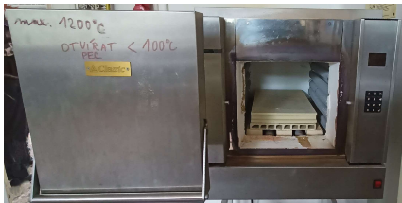
Obr. 4-3 Rychlovýpalová komorová pec výrobce Clasic s maximální teplotou 1200°C.
