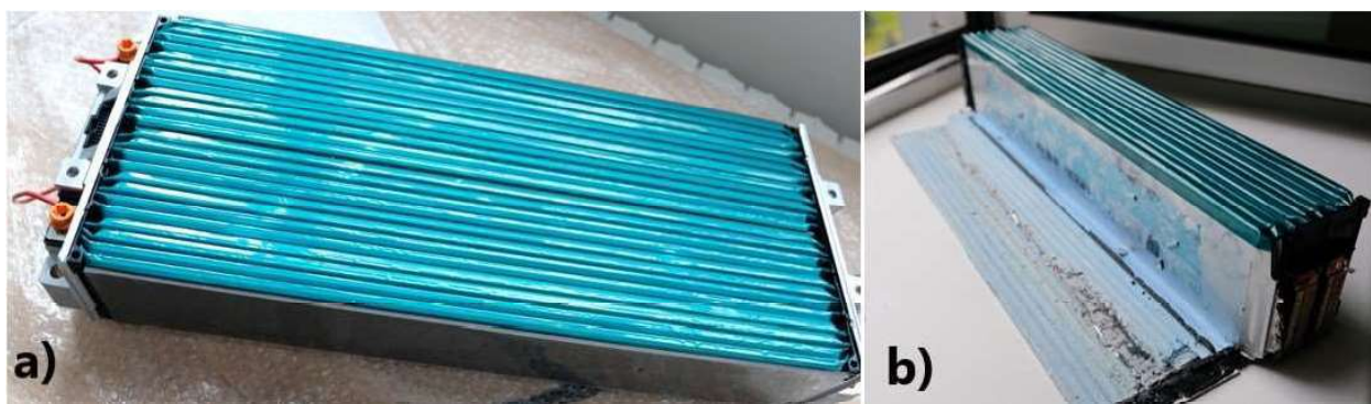
Obr. 4-5 a) Bateriový modul s odstraněným krytem. b) Zbýlý kryt modulu s přilepenými články.
