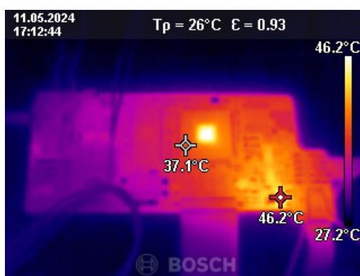
Obrázek 8.1: Termografický snímek desky plošných spojů.
