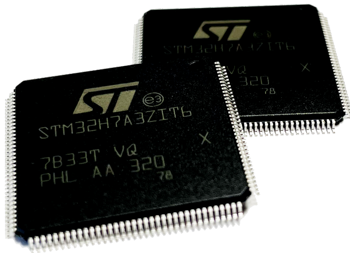
Obrázek 4.2: Vybraný mikrokontrolér STM32H7A3ZIT6.
