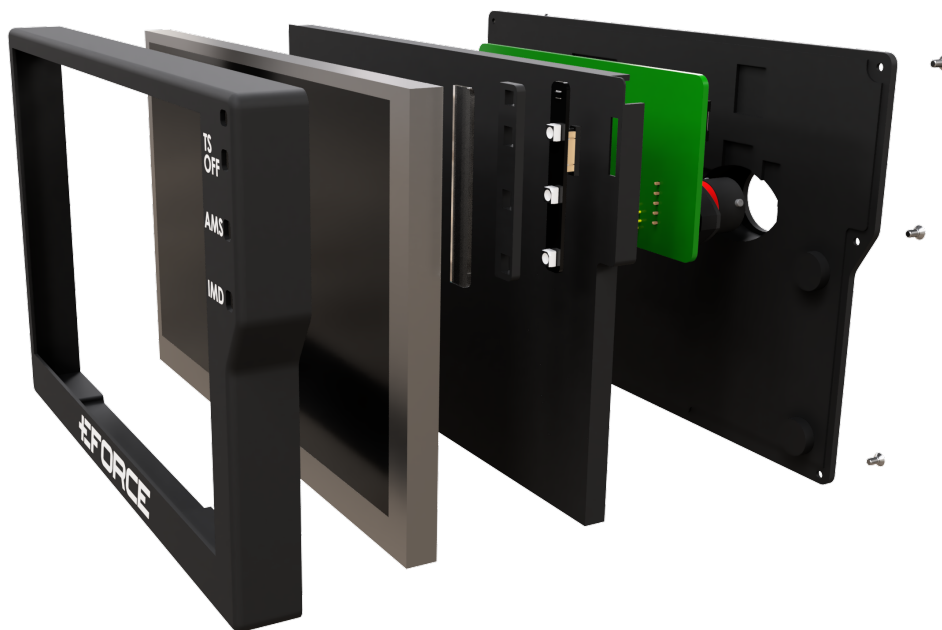
Obrázek 7.1: Render rozpadu mechanické zástavby.
