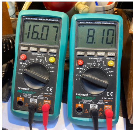
Obrázek 5.4: Vstupní a výstupní napětí snižujícího měniče
