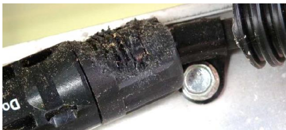
Obr. 17: Poškozený konektor hlodavcem (laboratoř ČVUT FEL)
