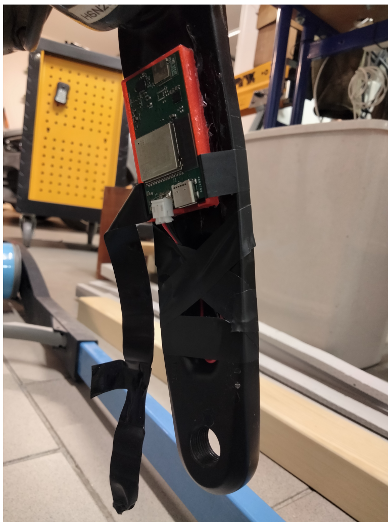
Obrázek 2.9: Osazená deska wattmetru nalepená na klice, pohled z profilu
