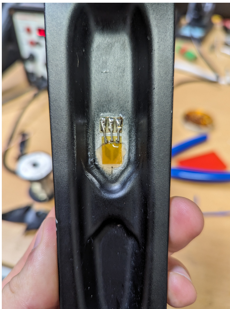
Obrázek 2.11: Tenzometr nalepený na klice Sram NX Eagle
