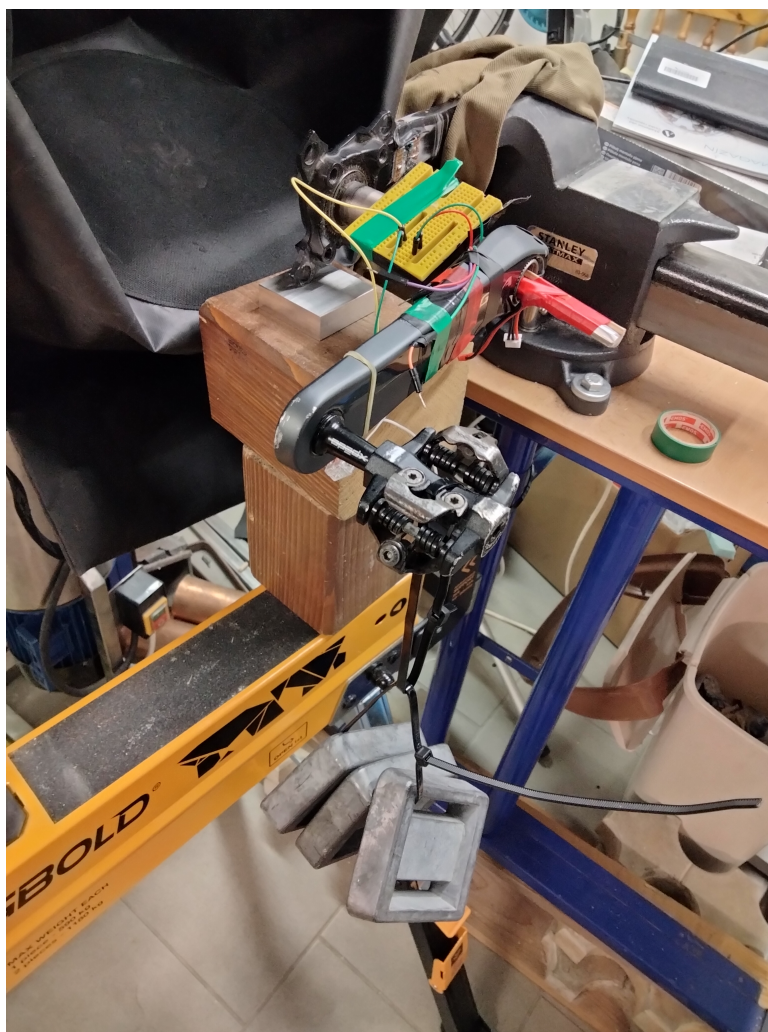
Obrázek 5.1: Verifikace měření točivého momentu známým závažím
