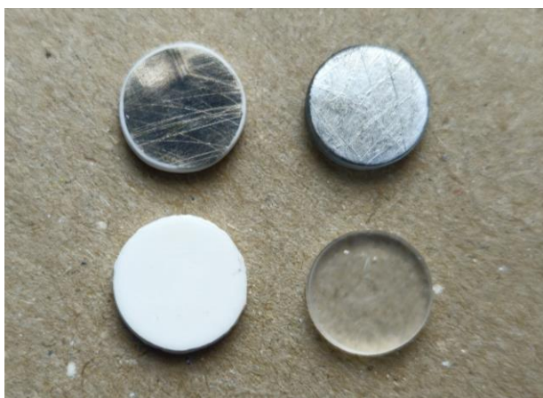
Obr. 2-4 Vzorky s napařenými elektrodami (nahore) a bez elektrod (dole)
