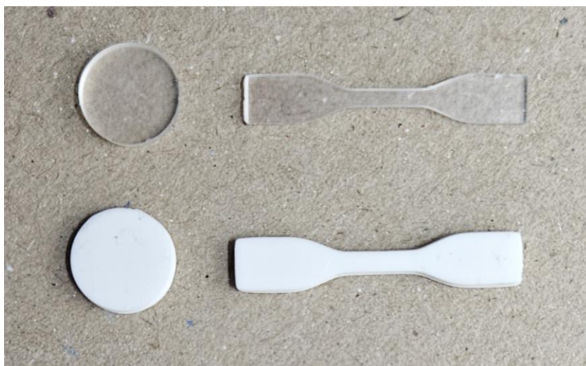
Obr. 2-2 Fotografie vytištěných vzorků s plnivem 30 % (dole) a bez plniva (nahore)
