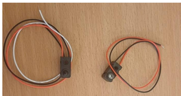
Obrázek 23 - Senzory tvořící IR bránu
