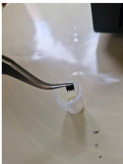
Obr. 14: Očištění vývodů v tavidle (vlastní)
