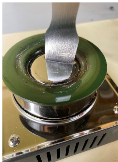
Obr. 13: Odstranění vrstvy oxidů (vlastní)
