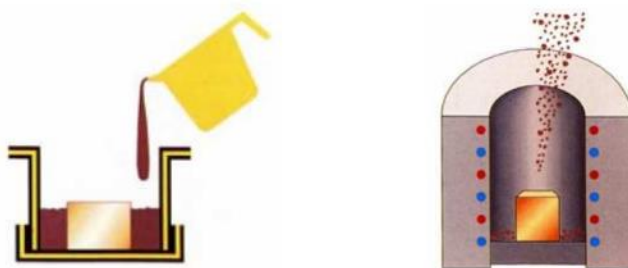
Obr. 14 Preparace za studena (vlevo) preparace za tepla (vpravo) [20]
