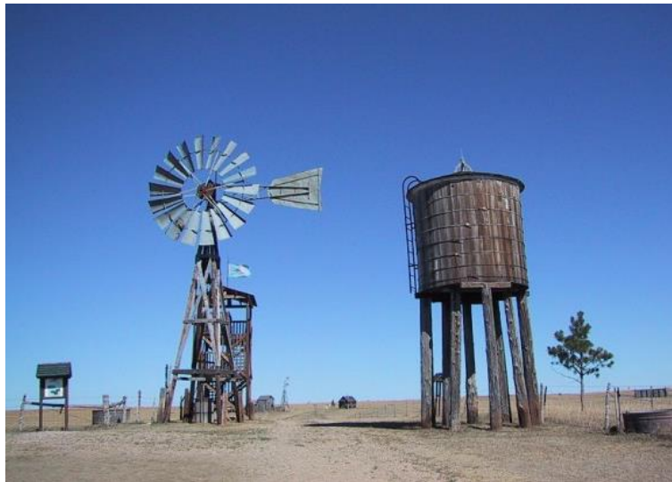
Obr. 1.2 – Větrný mlýn pro čerpání vody na americkém středozápadě [5]
