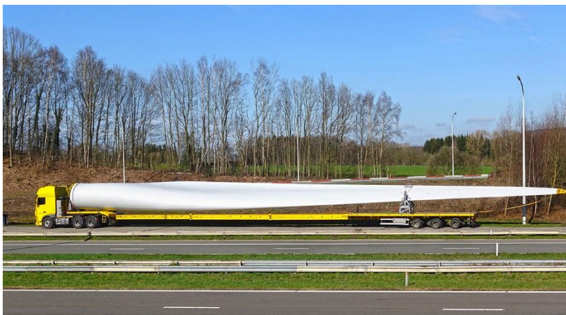
Obr. 3.5 – Tahač přepravující list větrné elektrárny [7]
