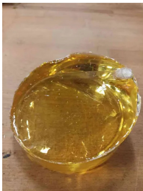
Obr. 2.3: Vytvrzená epoxidová pryskyřice s viditelným odlomením [11]
