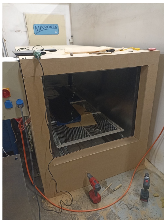
(b) Obložení pece se zakrytým vstupem
