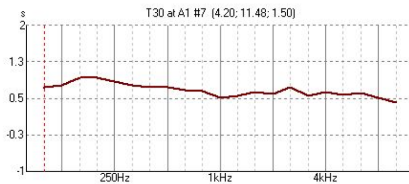
Obrázek 11.6: Graf frekvenční závislosti doby dozvuku z modulu AURA
