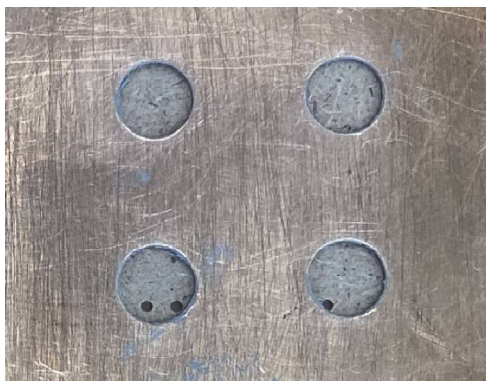
Obrázek 10: šablona, použitá při šablonového tisku pájecích past
