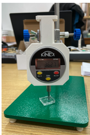
Obrázek 4.4 Fotografie pracoviště pro měření tloušťky pomocí úchylkoměru KINEX IP 54, 0-12,7 mm.
