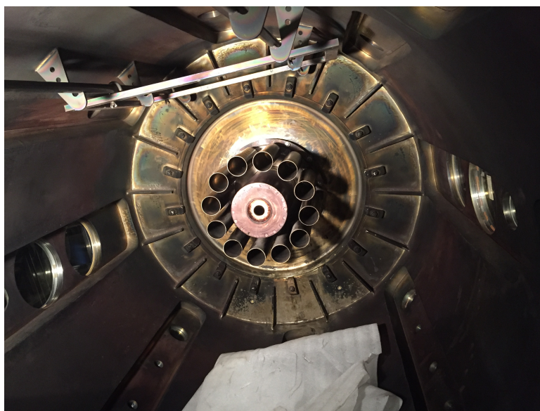
Obrázek 2.6: Pohled do komory PF-1000 na elektroodový systém [archiv autora].
