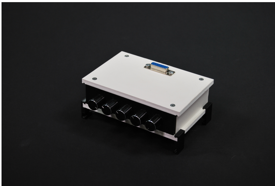
Obrázek 4.6: Realizace směšovacího modulu
