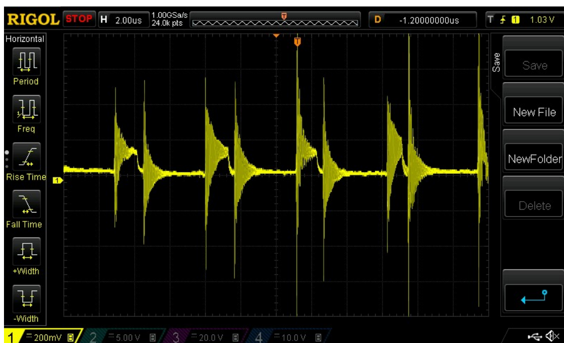
Obrázek 35: Průběh signálu proudového transformátoru, zátěž 220 \Omega
