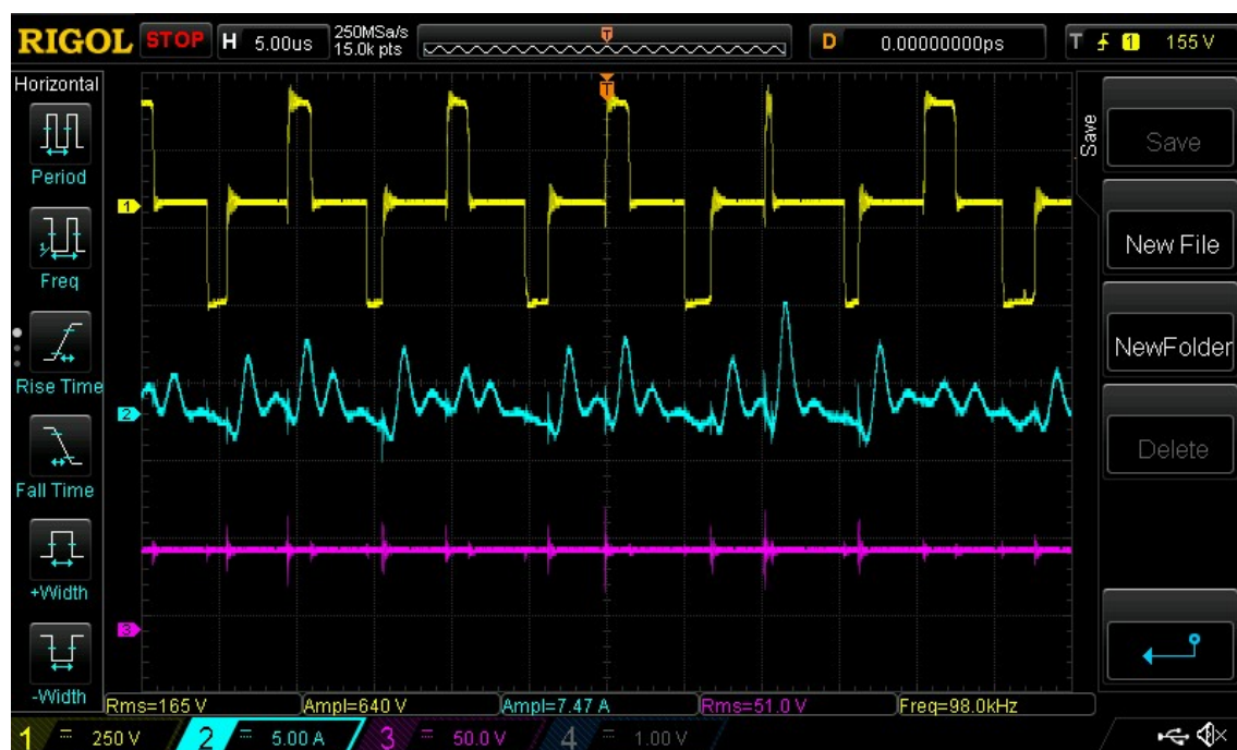
Obrázek 37: Průběh primárního napětí a proudu, zátěž 220 Ω
