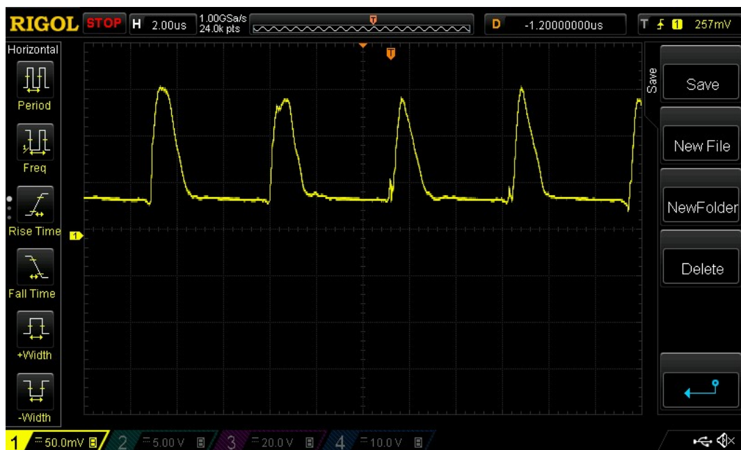
Obrázek 36: Průběh signálu proudového transformátoru (průměr z 512 vzorků)
