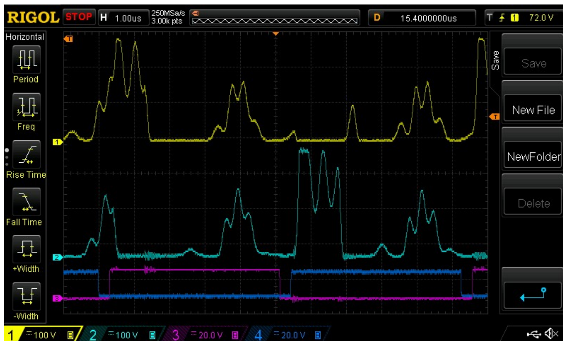
Obrázek 34: Průběhy přepětí na synchronních usměrňovačích
