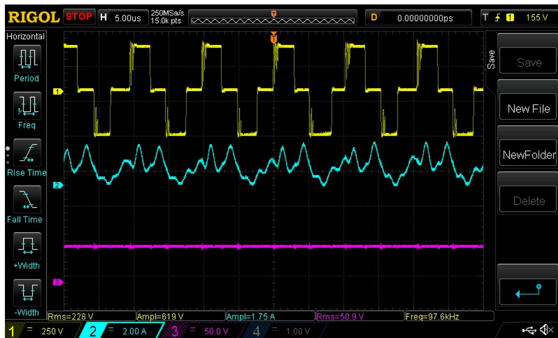
Obrázek 38: Průběh primárního napětí a proudu, zátěž 15 \Omega
