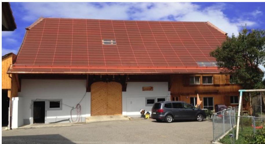
Obrázek 91 - Střešní fotovoltaické tašky integrované do historického chráněného objektů v Ecuwillens, Švýcarsko [80]
