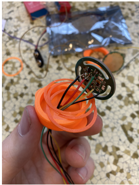
Obrázek 3.16: Tištěné podložky "spacery" pro lepší dotažování.
