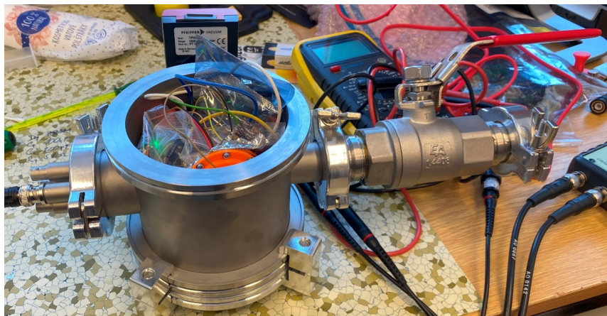
Obrázek 3.7: Zapojení pro měření ve vakuu.
