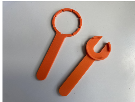
Obrázek 3.17: Tištěný utahovací držák a klíč.
