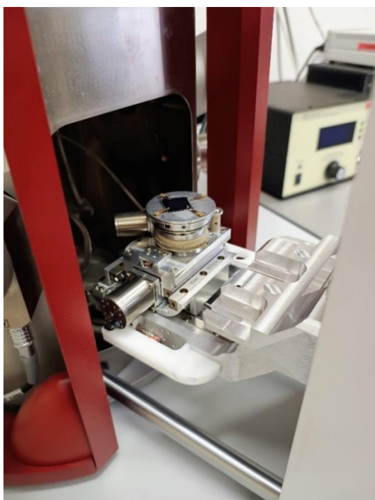
Obrázek 25 - detail, jak se vzorek do mikroskopu ukládá
