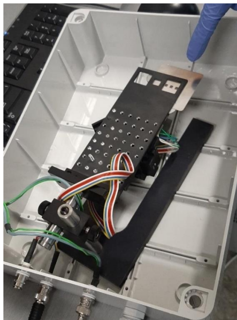
Obrázek 30 - ukázka, jak se vzorek ukládá pod světelný zdroj
