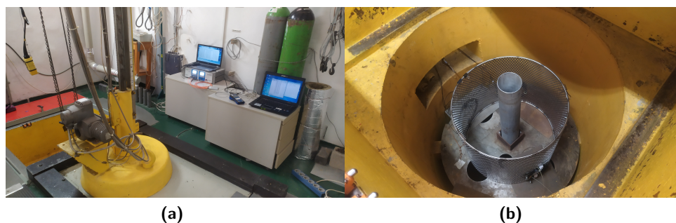
Obrázek 4.1 Přehledová fotografie ozařovací komory ROZA zachycuje a) ozařovací zdroj ROZA a realizované měřicí pracoviště s přístrojem OFT-4212MM, b) ozařovací komoru studnového typu s připojenými vzorky.
