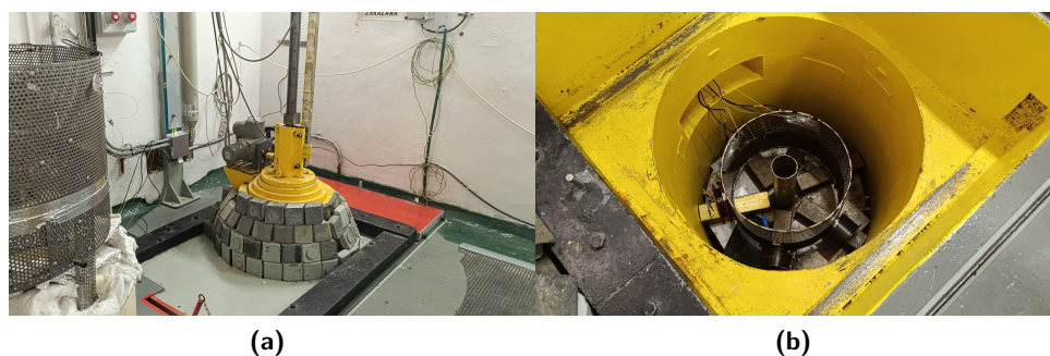
Obrázek 4.2 Přehledová fotografie ozařovací komory PRAZDROJ zachycuje a) ozařovací zdroj PRAZDROJ, b) ozařovací komoru studnového typu s připojenými vzorky.
