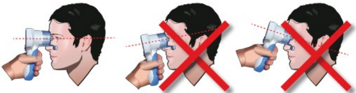
Obrázek 6 Správné měření pomocí pupilometru NPi-200 [65]
