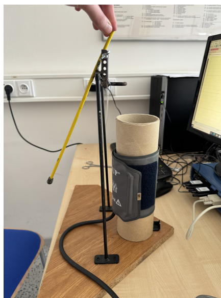
Obrázek 6.2: Měřicí přípravek pro zachycení impulzních odezví
