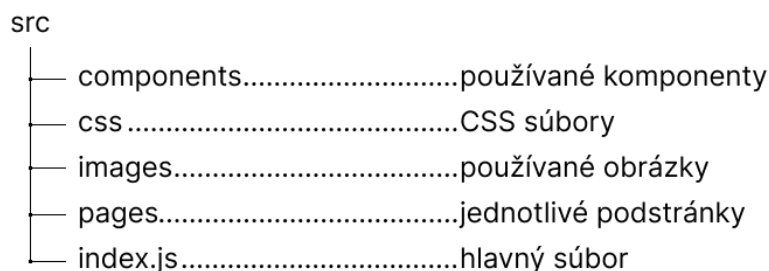
■ Obr. 4.5 Štruktúra frontendovej časti aplikácie
