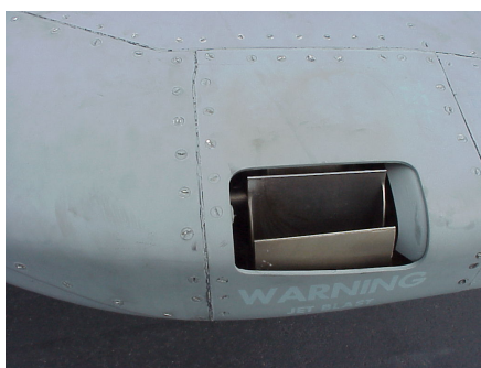
(a) : Detail trysky AV-8B Harrier II na konci křídla.
