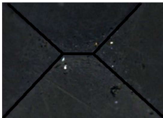
Obrázek 3.2: Fotografie hrotu skleněné pyramidy zachycená na konfokálním mikroskopu, kde byly zvýrazněny hrany sedlové střechy. Na fotografii je vidět, že pyramida nemá ostrý hrot, ale je tvaru sedlové střechy s délkou společné hrany 30\ \mu\text{m} a úhlu mezi protějšími stranami 165^\circ .
