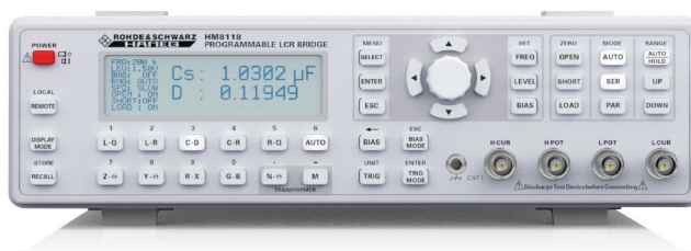
Obrázek 6.6. RLC metr HAMEG HM8118, převzato z [19].
