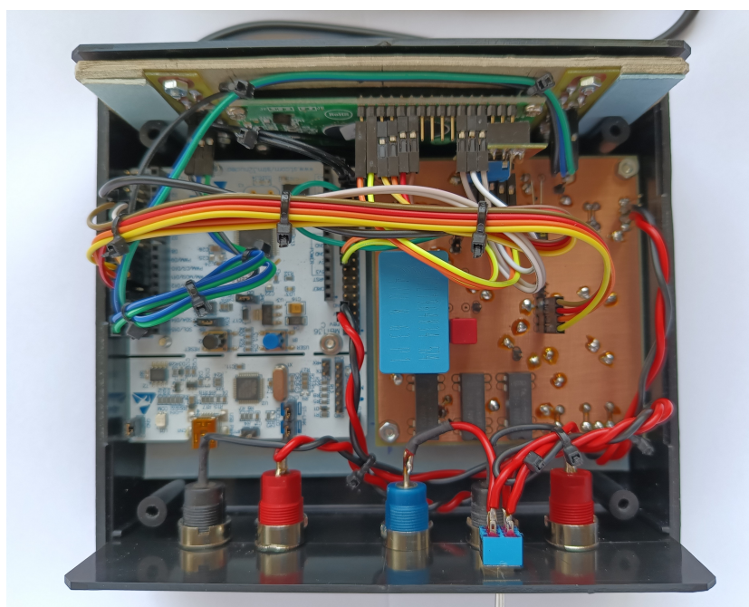
Obrázek C.2. Měřicí přípravek vestavěný do krabičky. Vlevo vývojová deska Nucleo-F446RE, vpravo vyrobená analogová deska.
