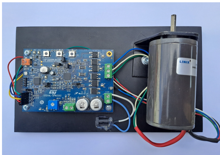
Obrázek 6.2. Evaluační deska STEVAL-SPIN3202 a použitý BLDC motor LINIX 45ZWN24-4
