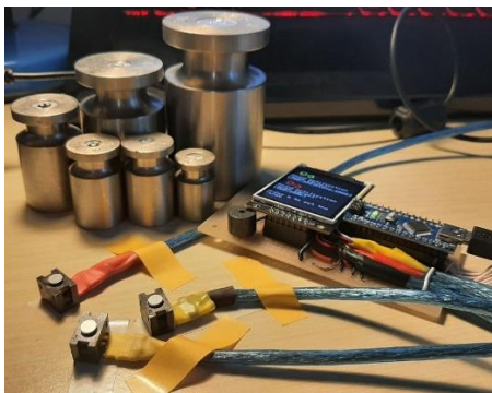
Obrázek 19: Kalibrace senzorů HONEYWELL FSG020WNPB
