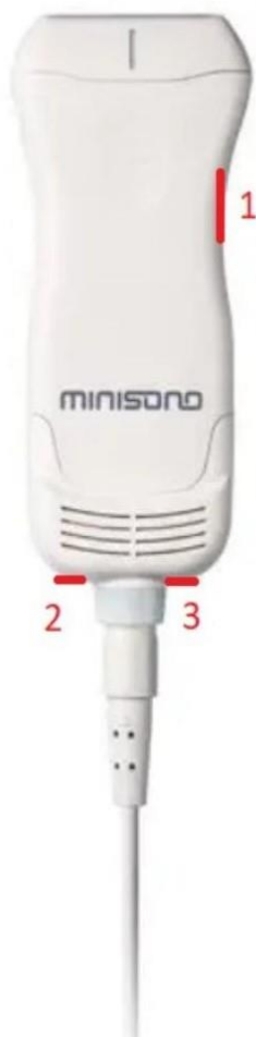
Obrázek 3: Návrh rozmístění senzorů na sondu
