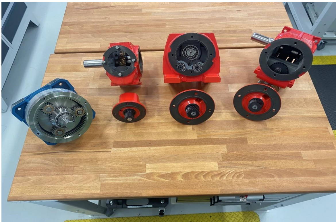
obr.8. cvičné převodovky (planetová, šneková, čelní a kuželová)
