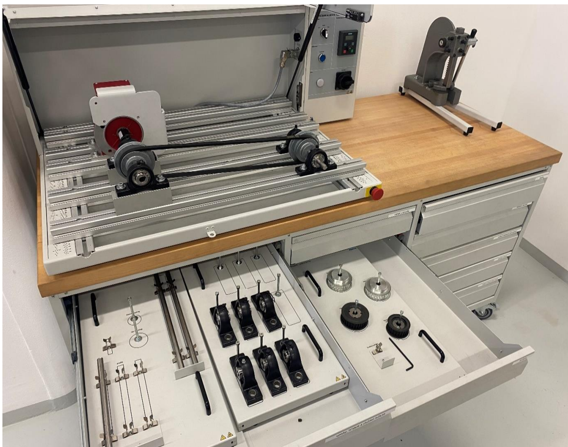
obr.10. pracovní stůl pro sestavení mechanických převodů
