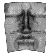
Trojúhelníková síť získaná optickým skenováním modelu Faraona
