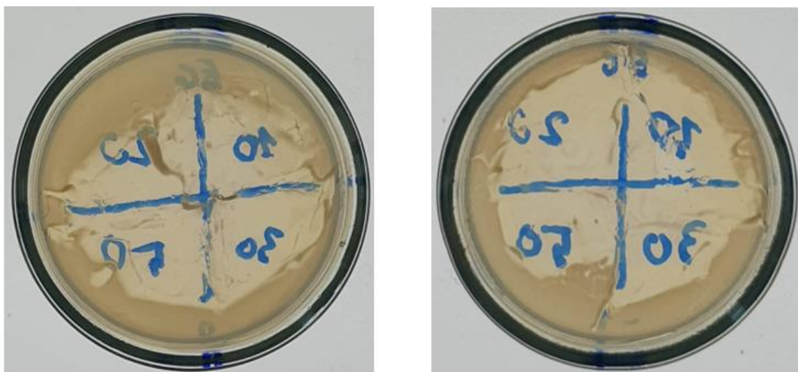
Obrázek 39: Vlevo fotka koncentrace 10^0 a vpravo fotka koncentrace 10^{-1} , na kterých byla hliníková fólie přiložena 24 hodin
