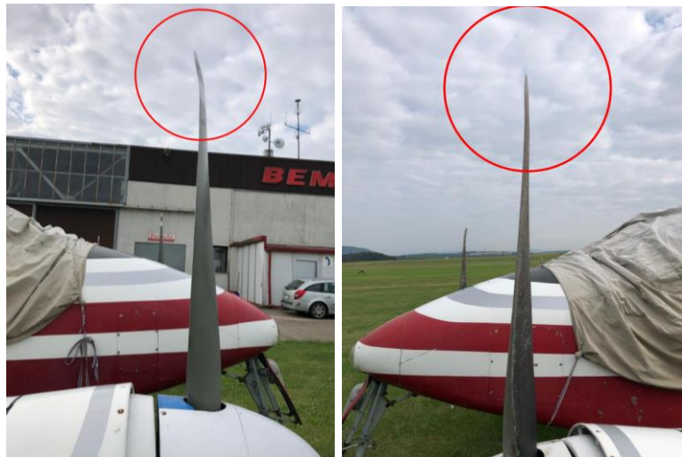
Obrázek 15: Poškození vrtulových listů pravé pohonné jednotky po nehodě [13]
