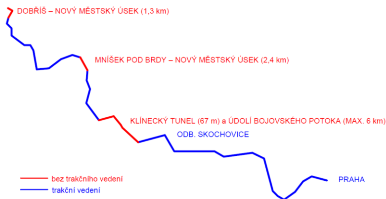
obr. č. 82 – podoba elektrizace v případě nasazení lehkých kolejových vozidel s nízkým dojezdem na akumulátory, zdroj: autor
