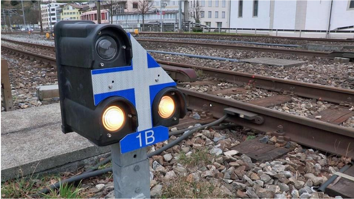
Obrázek 47 – Seřaďovací návěstidlo ETCS ve Švýcarsku [37]
