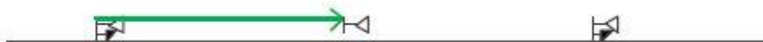
Obrázek 31 – Seřaďovací návěstidla ETCS (černý trojúhelník) nemusí být umístěna u všech návěstidel platných pro jízdu vlaku (bílý trojúhelník) [19]
