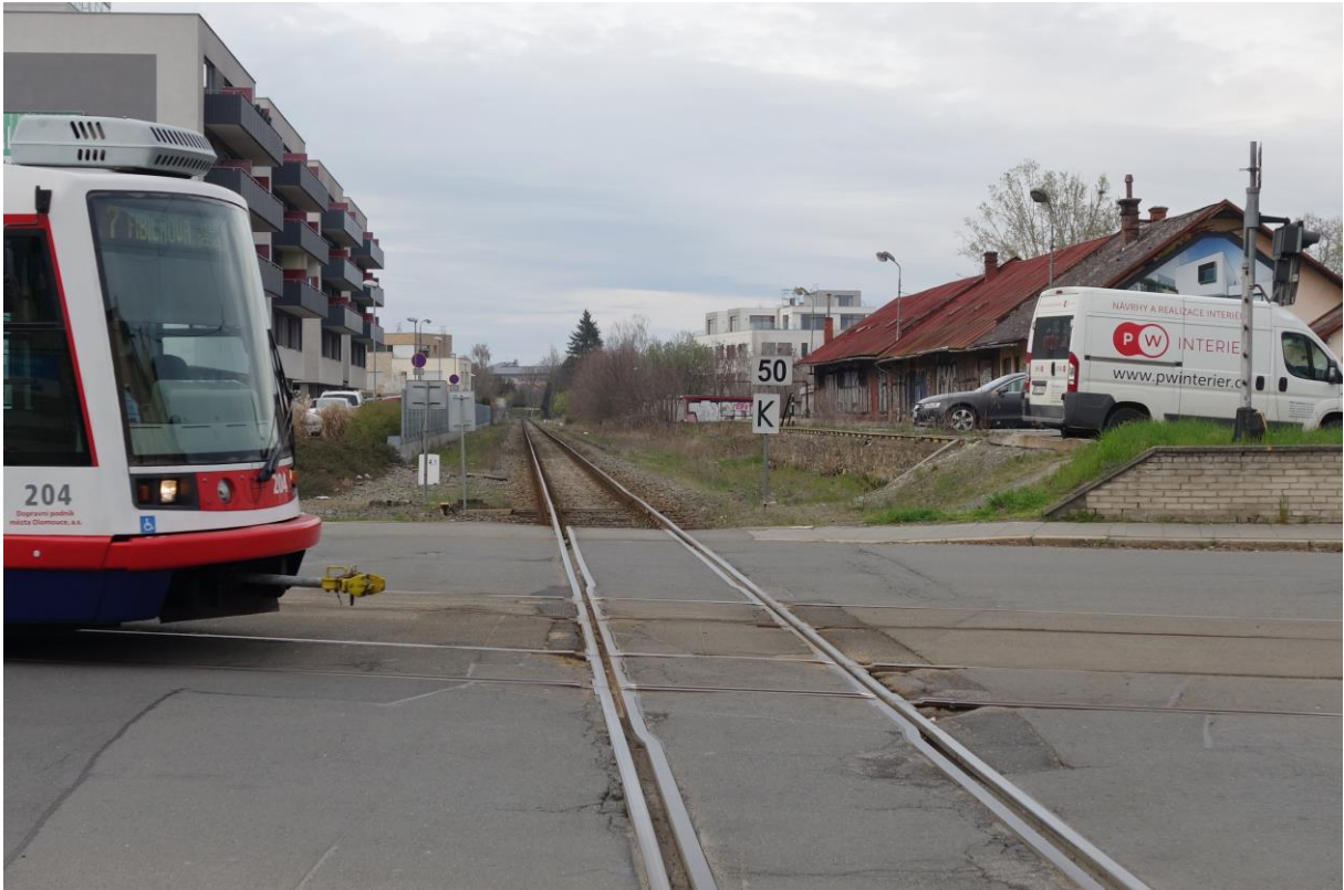
Obrázek 8: Kolejové křížení železniční a tramvajové tratě v km 4,064 (foto autor, 2024)
