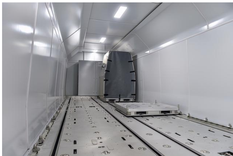
Obr. č. 10: Systém kolejnic se speciálními kontejnery v jednotce CR400BF, zdroj: [24]
